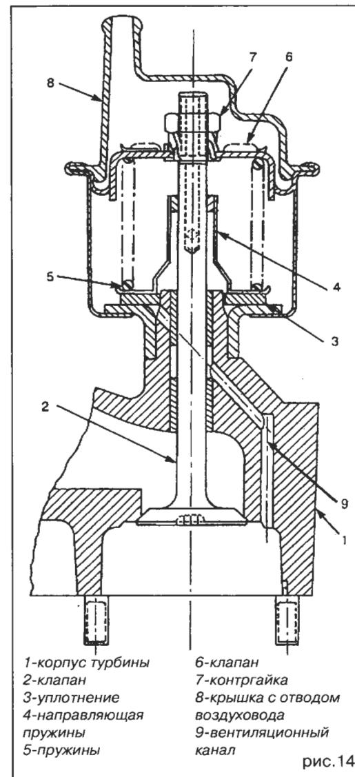
Этот клапан также может быть встроен в выхлопную трубу, как отдельно от корпуса турбины, так и в ней.
