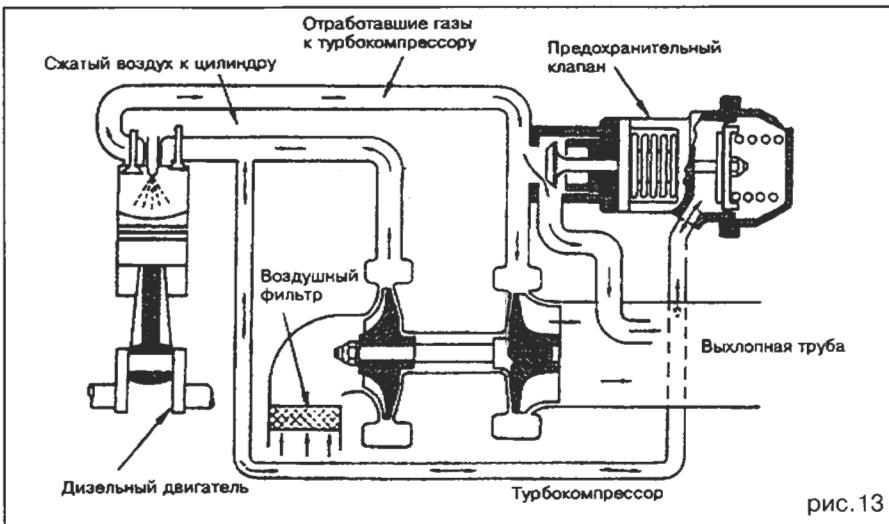
открывается регулировочный клапан, уменьшая поток отработавших газов через турбину и удерживая таким образом давление наддува ниже определенного предела, при превышении которого двигатель был бы поврежден.
