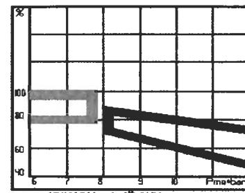
Соотношение масса/мощность Частотный диапазон двигателей в зависимости от давления нагнетания
