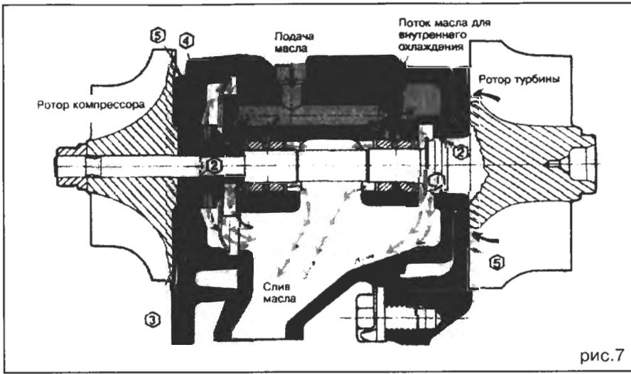
Уплотнительные кольца являются элементом, играющим главную роль в обеспечении герметичности. Кроме того, они передают тепло с оси на корпус.
