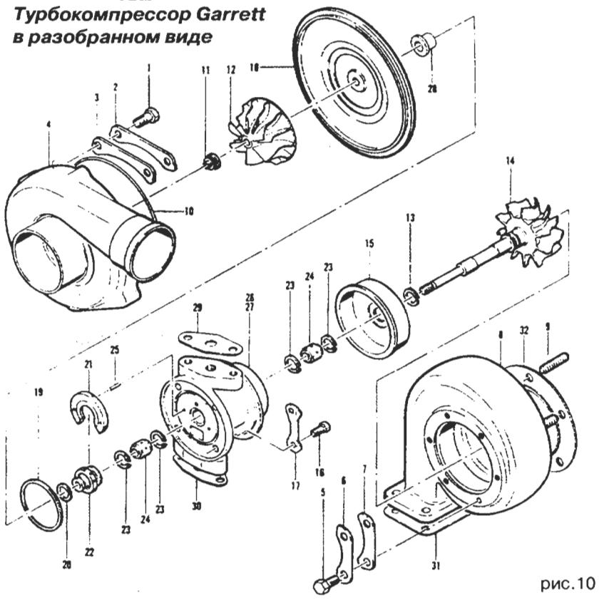
В случае возможного образования разрежения в компрессоре газы засасываются легче, чем более тяжелое масло. Со стороны турбины проблема отвода масла не так важна, если принять во внимание, что в нормальных условиях давление в турбине всегда выше, чем в корпусе оси. При некоторых условиях эксплуатации может иметь место падение давления в турбине; в таком случае требуется установка пластины для отвода масла со стороны турбины.
