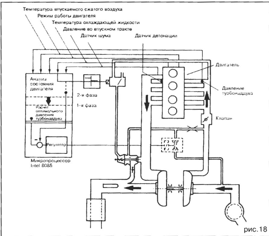
Эта механическая регулировка, тем не менее, не позволяет полностью использовать энергию отработавших газов.
