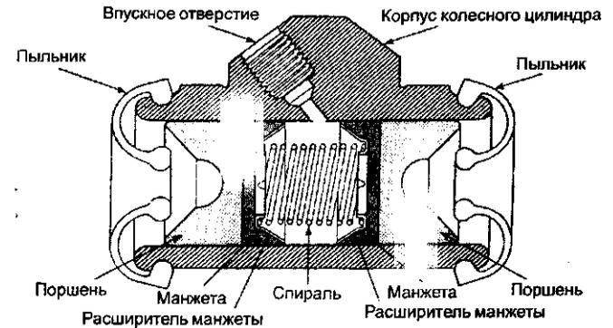
Давление, создаваемое в главном тормозном цилиндре, прижимает манжеты в колесных цилиндрах, чтобы таким образом привести в действие тормозные колодки (рис. 6.32).
