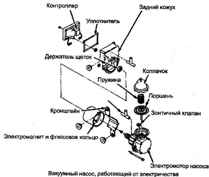
Вакуумный насос, работающий от электричества
