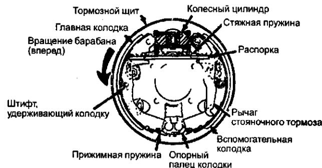
При включении тормоза колодка заставляет регулировочный механизм перемещаться наружу в процессе ее перемещения
