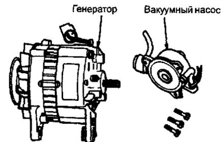
Вакуумный насос, работающий от автомобильного генератора
