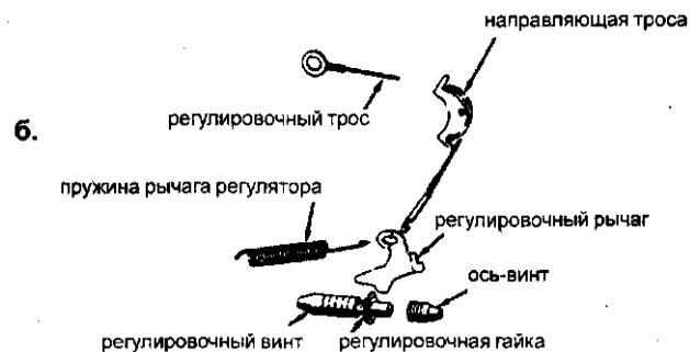
б. Детали автоматической регулировки зазора между тормозной накладкой и рабочей поверхностью барабана
