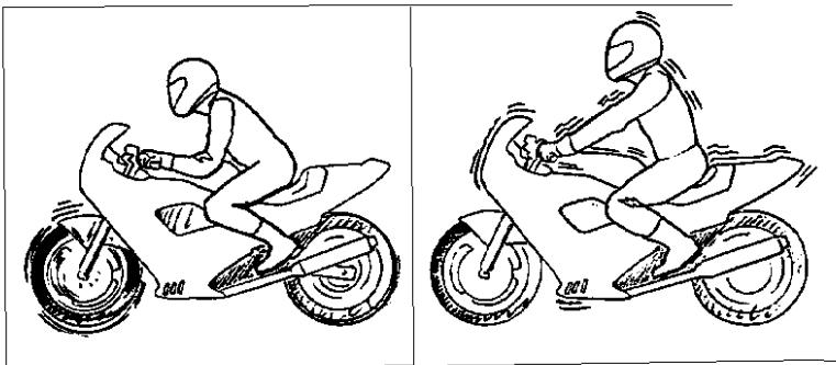
**Если вы в расслабленном состоянии, рыскает только передок. Если вы напряжены - колебания через ваше тело передаются на весь мотоцикл.**
